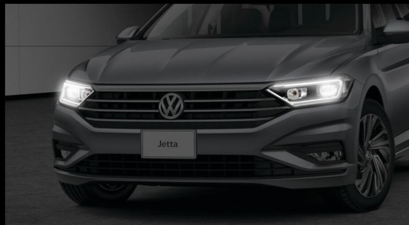
Mientras el sistema **Coming & Leaving Home** activará los faros de forma automática cuando desbloquee las puertas con el control de tus llaves y se apagarán después de un determinado tiempo.
